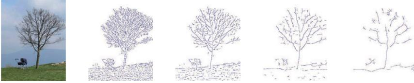
FIGURE 3.28 – Image d’un arbre et les crêtes détectées à différentes échelles. De gauche à droite :  $\sigma_1 = \sqrt{2}$ ,  $\sigma_2 = 2$ ,  $\sigma_3 = 2\sqrt{2}$ ,  $\sigma_4 = 4$ .
