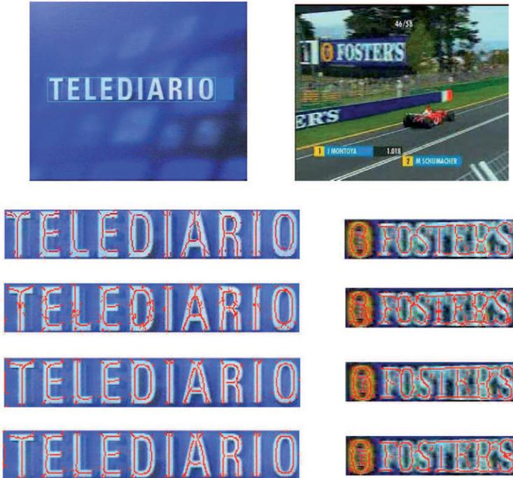
FIGURE 3.18 – De haut en bas, l'image originale du texte, le résultat de détection à l'échelle  $\sigma = 4$  (avec le texte "TELEDIARIO") et l'échelle  $\sigma = 2$  (avec le texte "FOSTER'S") en utilisant 4 mesures : le Gaussien, la courbure de la courbe de niveau, la courbure principale, le Laplacien.
