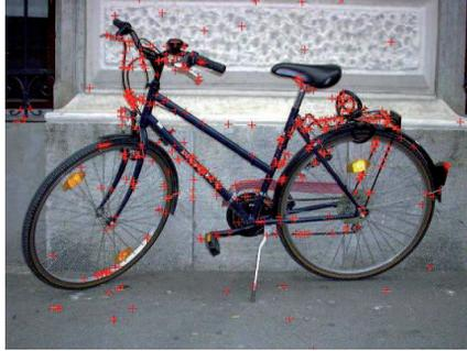
FIGURE 2.4 – Les 100 points les plus forts en énergie de Laplacien détectés par le détecteur Harris-Laplacien.
